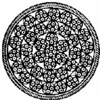
Slika 4.8. Jezgra kabela s koncentričnim slojevima
