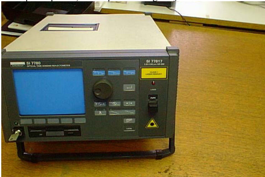
Slika 13.11. Optički reflektometar SI 7780 SCHLUMBERGER
