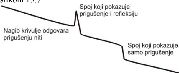
Slika 13.7. Karakterističan reflektogram spojeva na svjetlovodnoj niti
